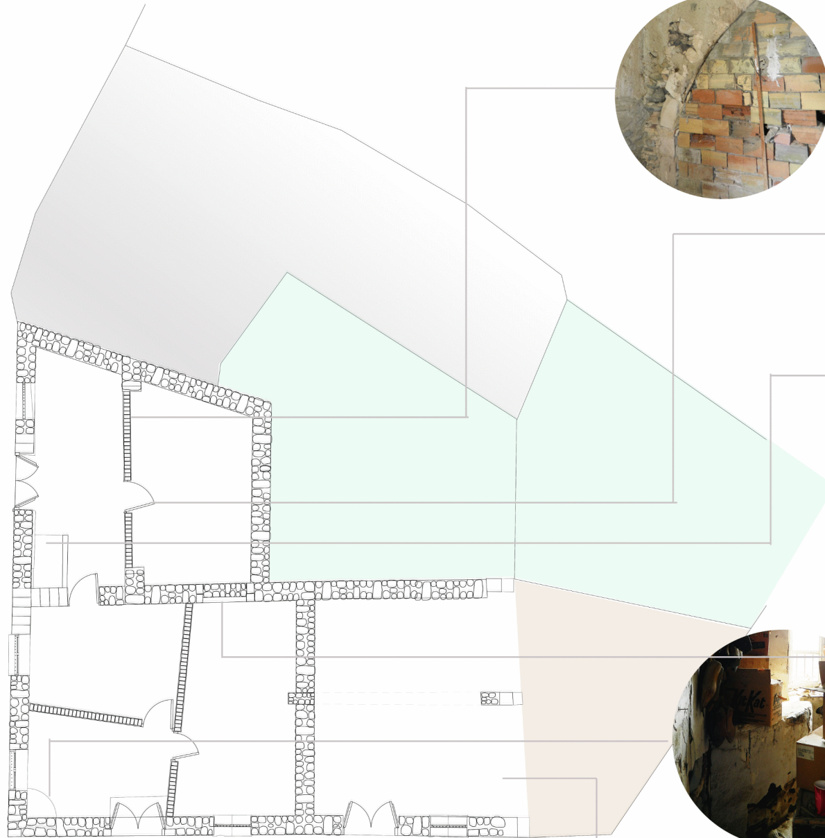
ΕΝΤΟΠΙΣΗ ΚΑΜΑΡΑΣ ΜΕΣΑ ΣΤΟΝ ΧΩΡΟ ΤΟΥ ΕΛΑΙΟΜΥΛΟΥ - ΥΠΑΡΧΗ ΔΙΧΩΡΟΥ ΠΟΥ ΕΧΕΙ ΚΛΕΙΣΤΕΙ ΜΕ ΣΥΓΧΡΟΝΑ ΤΟΥΒΛΑ ΓΙΑ ΤΟ ΔΙΑΧΩΡΙΣΜΟ ΤΟΥ ΧΩΡΟΥ
